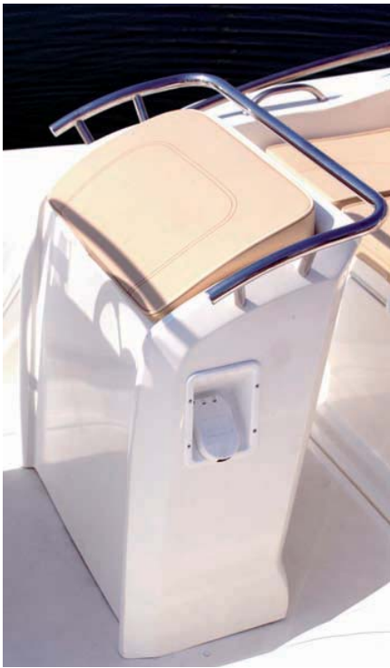
▲ El asiento 'bolster' tiene la toma de combustible en la banda
