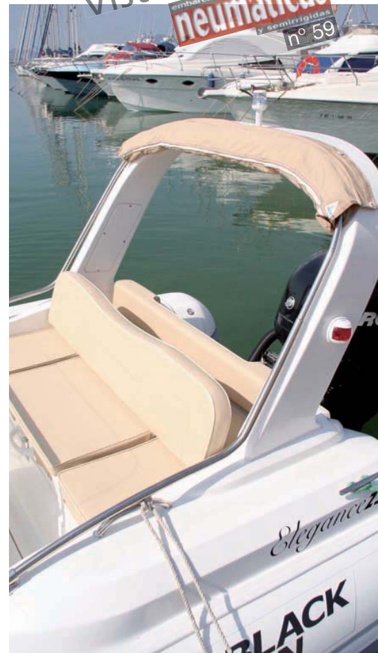
▲ El asiento de popa se sitúa bajo el arco de antenas de estructura moldeada
