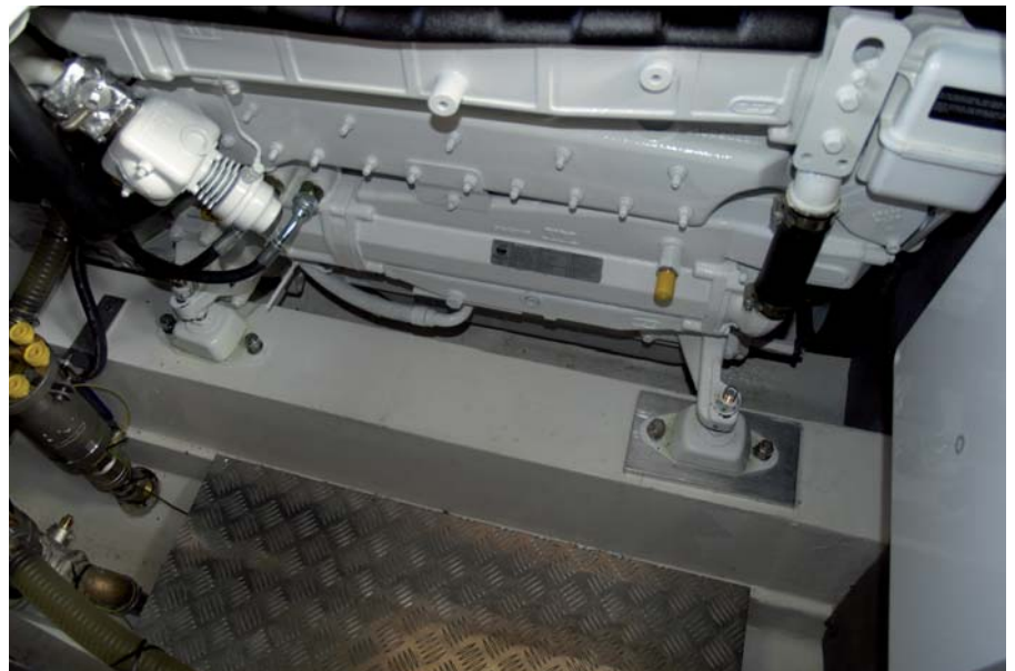
El CMD QSD4.2-270i, por su configuración, es un motor fácilmente accesible a sus puntos de mantenimiento periódico.
