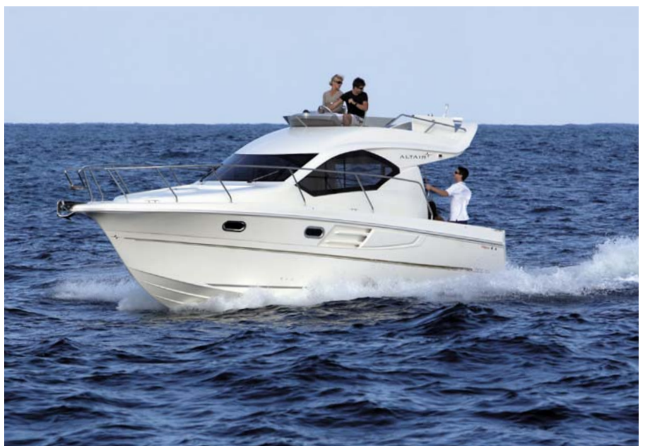
Con dos QSD4.2-270i, la Altair Zafir 32 disfruta de la máxima potencia homologada para su carena. Con el gas a fondo puede superar con facilidad los 32 nudos de punta.
