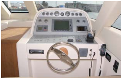
Los instrumentos se han colocado de forma racional en el puesto de gobierno, presidido por un sistema de navegación Raymarine E120.
