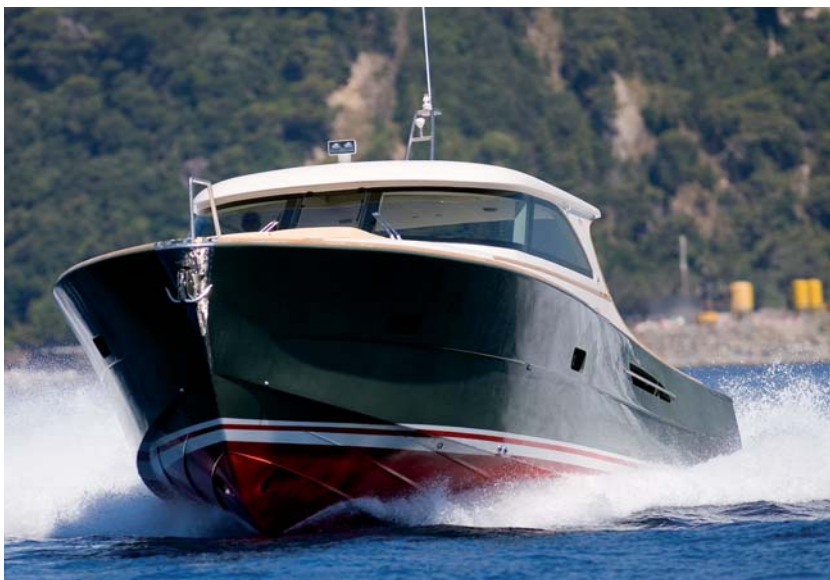
Con un trimado ajustado el Toy 51 nos ofreció una velocidad máxima de 33 nudos, lo cual habla positivamente del diseño de su casco.
