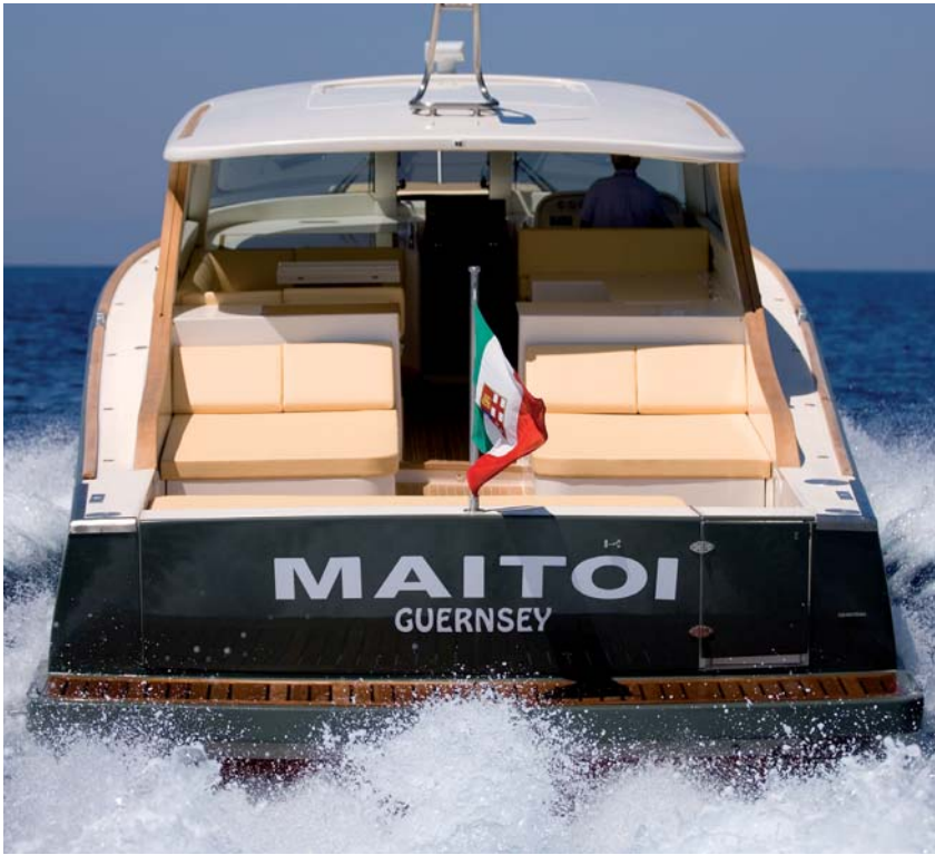
Al igual que sucedía con los yates clásicos, la popa del Toy 51 presenta una ligera forma de cola de castor, lo cual también redundará en una mayor estabilidad, al ganar manga en popa.
