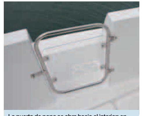
La puerta de popa se abre hacia el interior; en la banda, un imperceptible tope de goma evita los golpes.
