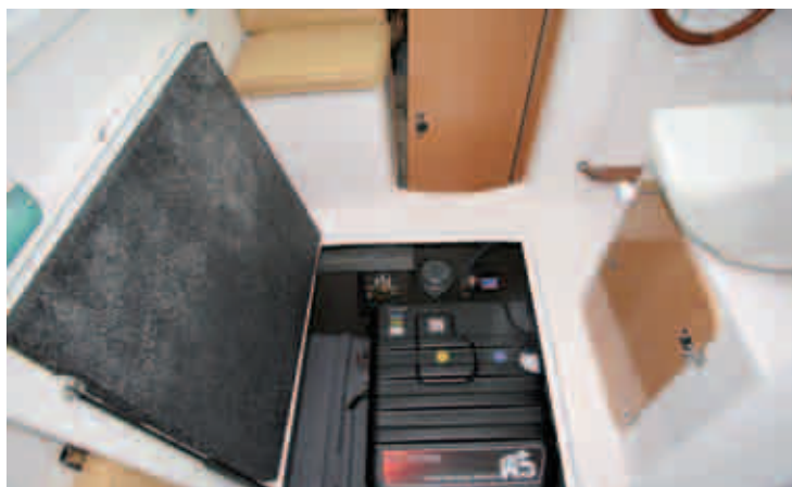
Una escotilla en el piso de la cubierta permite acceder a la sentina del
