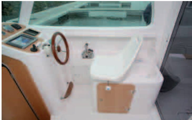
El asiento del patrón, regulable en aproximación, está dispuesto sobre el mueble de servicio.
