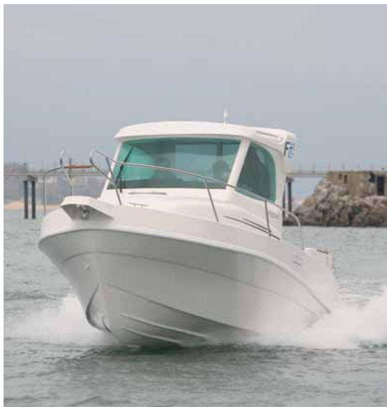
Los 150 Hp instalados en el Artaban F23 permiten a la embarcación desarrollar 23,5 nudos de máxima y planear en solo siete segundos.
