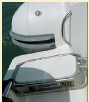
Bajo una pequeña plataforma de baño en babor se encuentra la escalera de baño, complementada por la ducha y un asidero en acero inox, para facilitar la entrada al agua y la salida.
