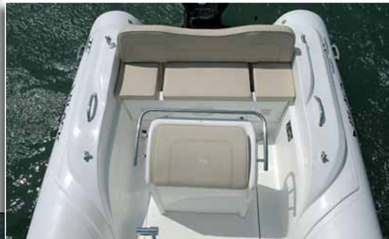
La bañera ofrece un asiento recto en popa para tres personas flanqueado por dos tarimas de fibra con asideros de acero inoxidable. Enfrente, y diseñado para la conducción erguida, se ha ubicado el asiento del piloto. ▼
