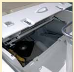
Levantando el asiento de popa mediante pistones hidráulicos, se accede, además de a los desconectores, baterías y sentina, a un gran espacio de estiba.
