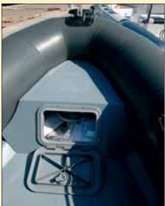
En la proa se habilita un cofre de estiba de acceso frontal en lugar del habitual pozo de anclas.
