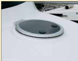
La escotilla redonda de la cubierta de proa es la responsable de la ventilación principal de esta cabina.
