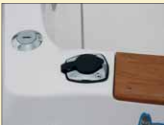
De serie, la embarcación incorpora un portacañas en cada banda con sus respectivas tapas de goma.
