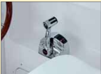
El mando del motor es electrónico y se ubica en la parte de estribor del puesto de gobierno.
