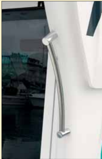
En los laterales de la cabina se instalan unos pasamanos de acero.
