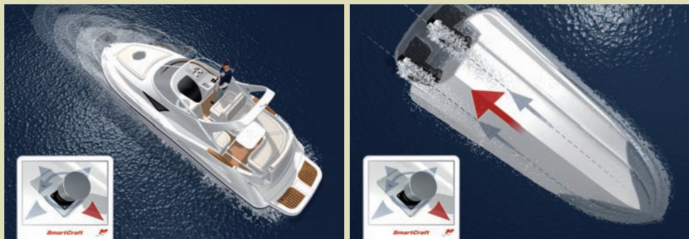
Desplazando el joystick hacia delante el barco avanza lentamente. Y para ciar, basta con pulsar la palanca hacia atrás.
