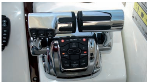
Además de las particularidades del sistema, se agradecen las nuevas palancas electrónicas de MerCruiser, por su diseño y ergonomía, y con diversas funciones de control, entre ellas poder sincronizar la aceleración en una sola palanca.
