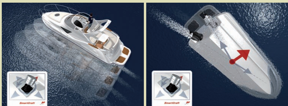
Desplazando el joystick hacia delante el barco avanza lentamente. Y para ciar, basta con pulsar la palanca hacia atrás.
