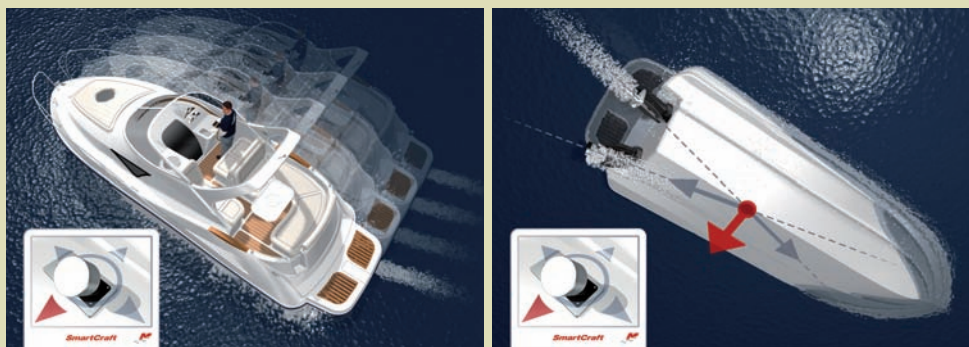
Los desplazamientos del barco a babor y a estribor lateralmente sólo requieren el movimiento hacia los lados de la palanca.
