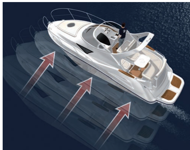
Una de las funciones opcionales adaptables al Axius es el Skyhook Electronic Anchor, que permite mantener el barco en un mismo punto, compensando los efectos del viento y la corriente.
