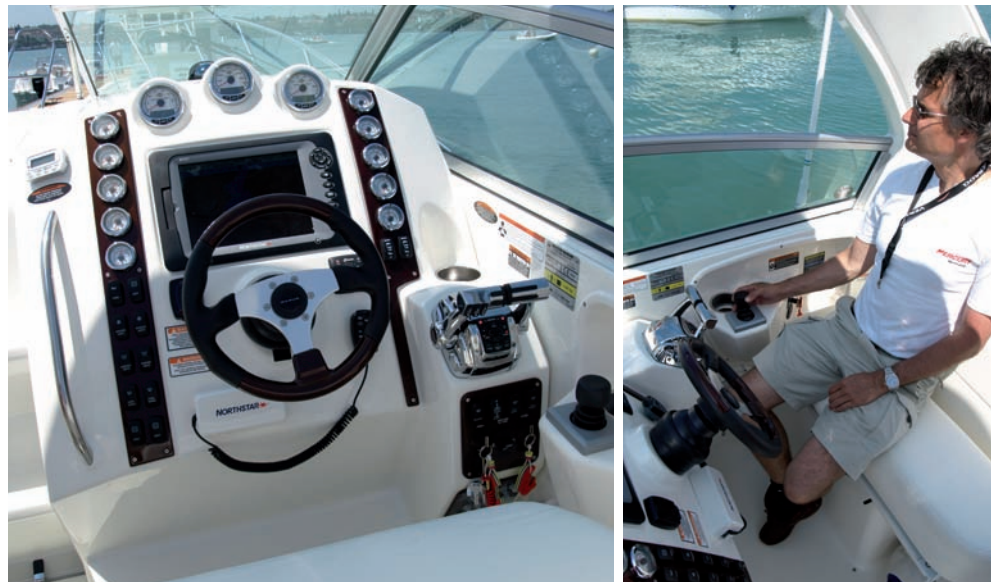
Con sólo dos dedos el piloto puede controlar el joystick que facilita el movimiento del barco en cualquier sentido.
