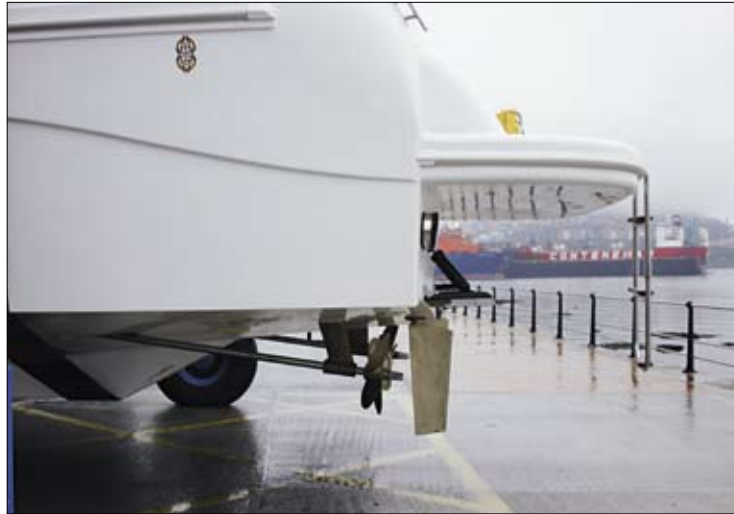
Detalle de la popa sin túneles con la plataforma adosada, la escalera de baño desplegada, quilla, palas de timón y flaps hidráulicos.
