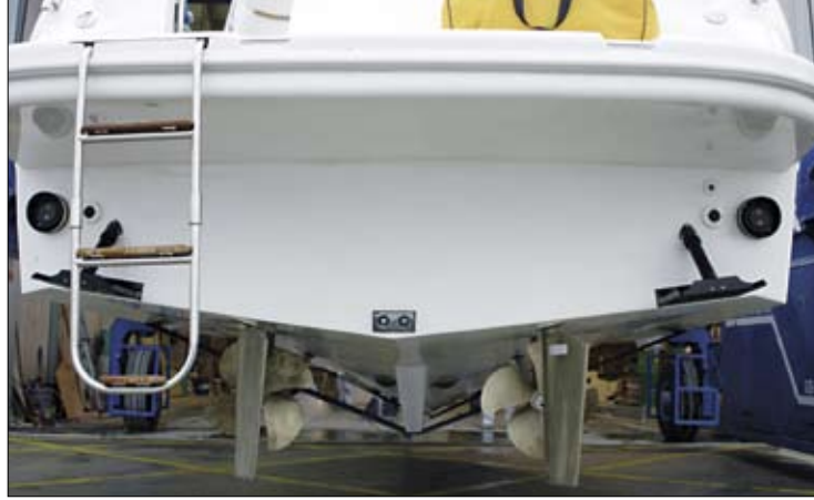
Detalle de la popa sin túneles con la plataforma adosada, la escalera de baño desplegada, quilla, palas de timón y flaps hidráulicos.
