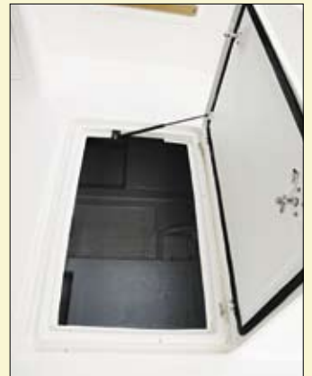
Para pertrechos se ha instalado en el centro de la bañera un gran cofre con dos cierres y un amortiguador.
