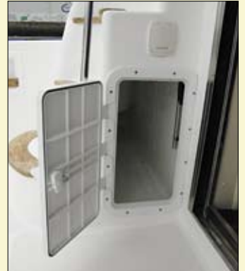
Los laterales estructurales del fly se han aprovechado para ubicar espacios de estiba adicionales.
