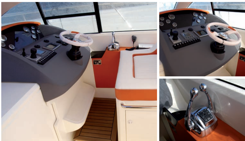
El puesto de gobierno de la Astondoa integra en su panel de gobierno todos los elementos que Cummins Zeus ofrece de serie: palancas electrónicas, pantalla Smart Craft y joystick de maniobra.
