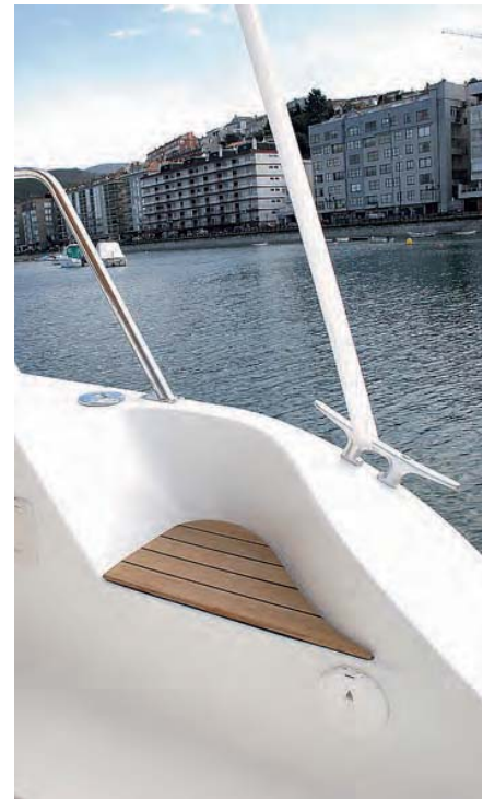
Este peldaño de acceso a bañera salva la altura de la borda interior.
