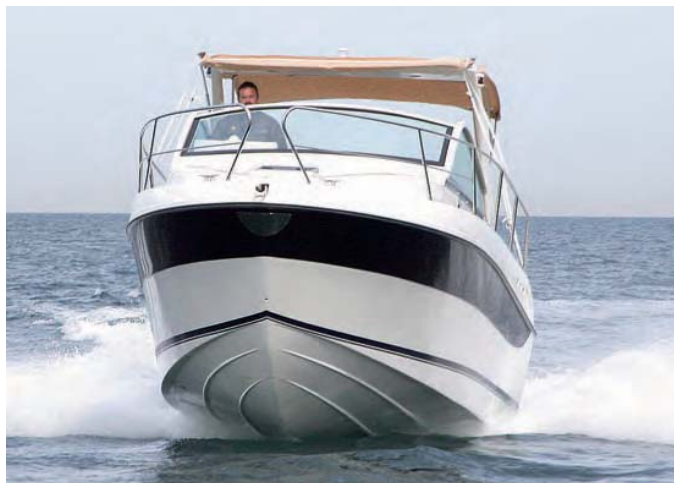
La carena en forma de V cuenta con seis sprays.
