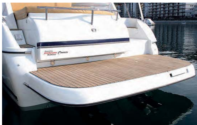
La plataforma de baño se reviste de teca y oculta una escalera plegable.
