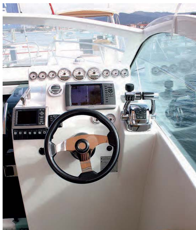
El puesto de gobierno se ha instalado a estribor y ofrece asiento a dos personas.
