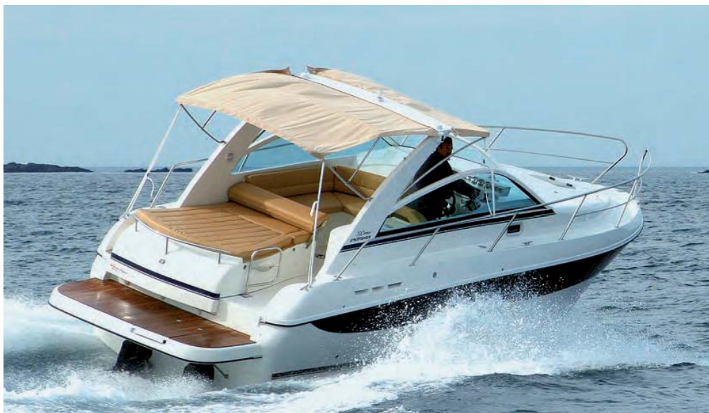
La unidad probada se equipó con dos motores intransbordada Mercury MerCruiser de gasolina, modelo 5.0MPI
