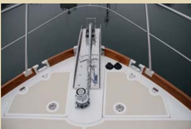
El espacio de maniobra de fondeo dispone de buenos cofres para el molinete. El ancla se estiba en su roldana.
