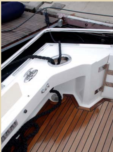
Los pasamanos de inox están sobredimensionados y los pasacabos de amarre están reforzados con inox.
