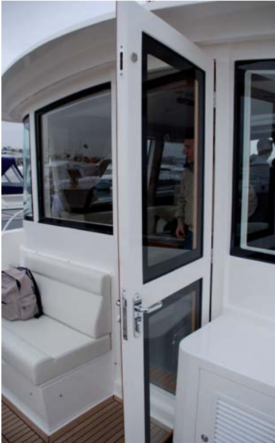
La puerta de acceso a la caseta es de una sola hoja y está flanqueada por dos grandes cristalerías que proporcionan visibilidad desde el interior y luz.
