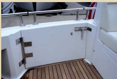
Todo es robusto y de una eficaz sencillez mecánica: grandes goznes y un simple cerrojo de inox para cerrar la puerta de acceso a la bañera.
