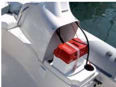
Entre los numerosos detalles, está el sistema para guardar la batería, a salvo del agua de la bañera, seca y protegida.
