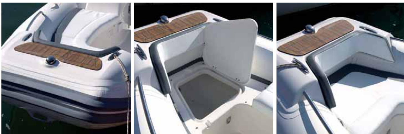
Dos vistas de la proa. El cofre es lo suficientemente voluminoso como para guardar toda la línea de fondeo, aunque carece de roldana.
