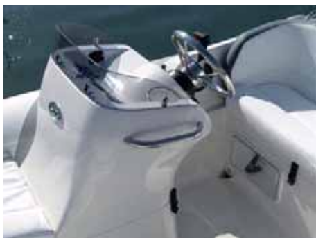
El parabrisas es bajo para que el ténider se pueda estibar en un garaje de un barco mayor.
