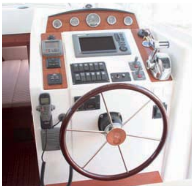
La consola de gobierno principal se encuentra junto a la puerta de entrada lateral
