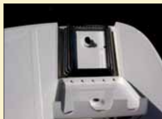
La escalera de baño queda instalada en la plataforma de baño, que incorpora una tapa especialmente diseñada para cubrirla.
