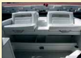
Los asientos de popa esconden un par de cofres de estiba. Además, al levantarse el módulo, que incluye el solárium, nos da acceso a la sala de máquinas.
