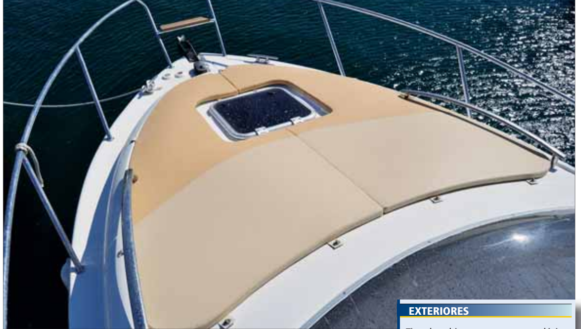
▲ La cubierta de proa, sobreelevada, brinda una superficie de 1,60 x 1,80 metros, opcionalmente acolchada, protegida a ambos costados por unos robustos pasamanos de acero inox.
