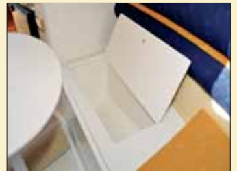
El espacio de estiba destinado a la cabina se reparte entre los cofres situados bajo los asientos de proa y un pequeño armario ubicado en la banda de babor junto a la entrada.
