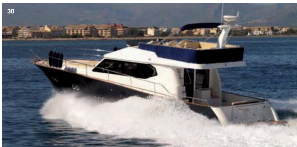
30. La Altair Zafir 50 Classic es un magnífico crucero de semidesplazamiento que con los dos Cummins de 715 Hp es capaz de mantener un régimen de crucero de 20 nudos a 1.850 rpm con el máximo confort
