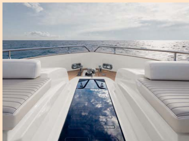
El pasillo central de proa tiene un tragaluz enrasado en el piso, que ilumina de forma natural la cabina VIP.
