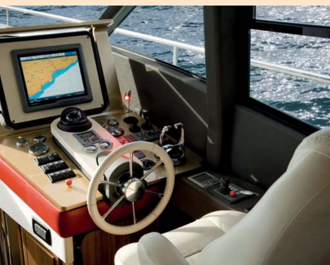
Los actuales sistemas de navegación permiten reducir el espacio ocupado en el puesto de gobierno.
