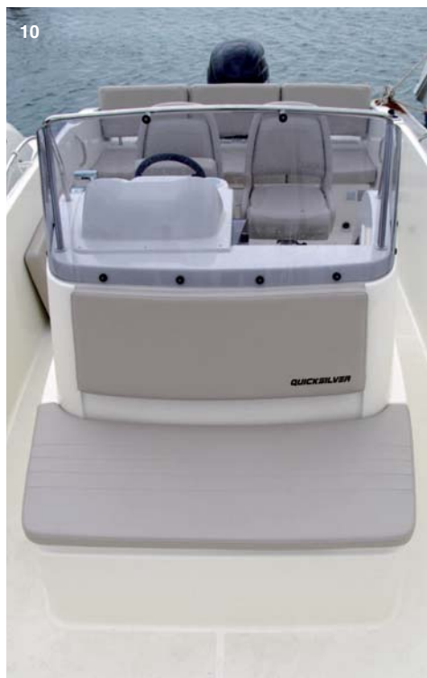
10. La consola de la 675 Open es más estrecha y deja pasos laterales a ambos lados.
