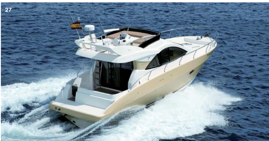
27. Con los dos Cummins QSD 4.2 320i la F360 es capaz de alcanzar los 30 nudos en las peores condiciones de mar y viento. Pero para mantener un buen régimen de crucero bastan los entre los 23 y los 25 nudos y las 2.300 y las 3.500 rpm.
