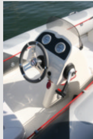
La distancia entre el piloto y la consola es adecuada. La palanca del gas está bien ubicada a Er.
