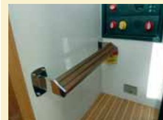
Un reposapiés de acero inoxidable y teca aportará un mayor confort a la postura de conducción.
