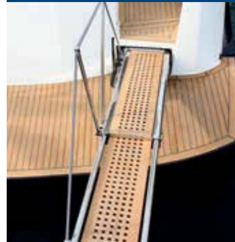
La pasarela hidráulica escamoteable.
