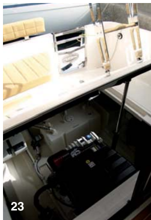
23 y 24. Dos vistas de la cámara de motores con CMD QSB 4.2 de 350 Hp con la correa de transmisión al Mastervolt de 7,4 kW
