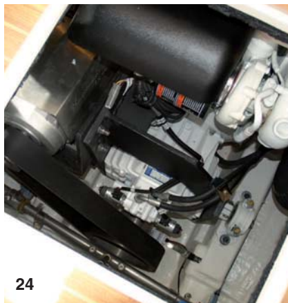
23 y 24. Dos vistas de la cámara de motores con CMD QSB 4.2 de 350 Hp con la correa de transmisión al Mastervolt de 7,4 kW
