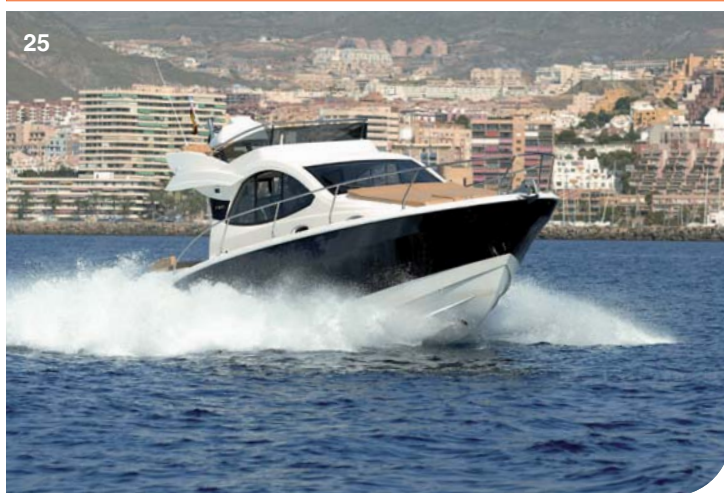
25. Con el Cummins de 350 Hp la F300 es capaz de superar holgadamente los 26 nudos de máxima en buenas condiciones de mar. Con las peores mantiene los 26 nudos o un crucero de 22 a 23 nudos.
