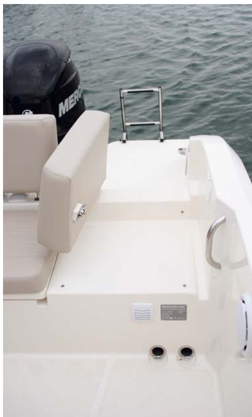
El respaldo actúa de puerta para cerrar el pasillo de entrada a la bañera.
