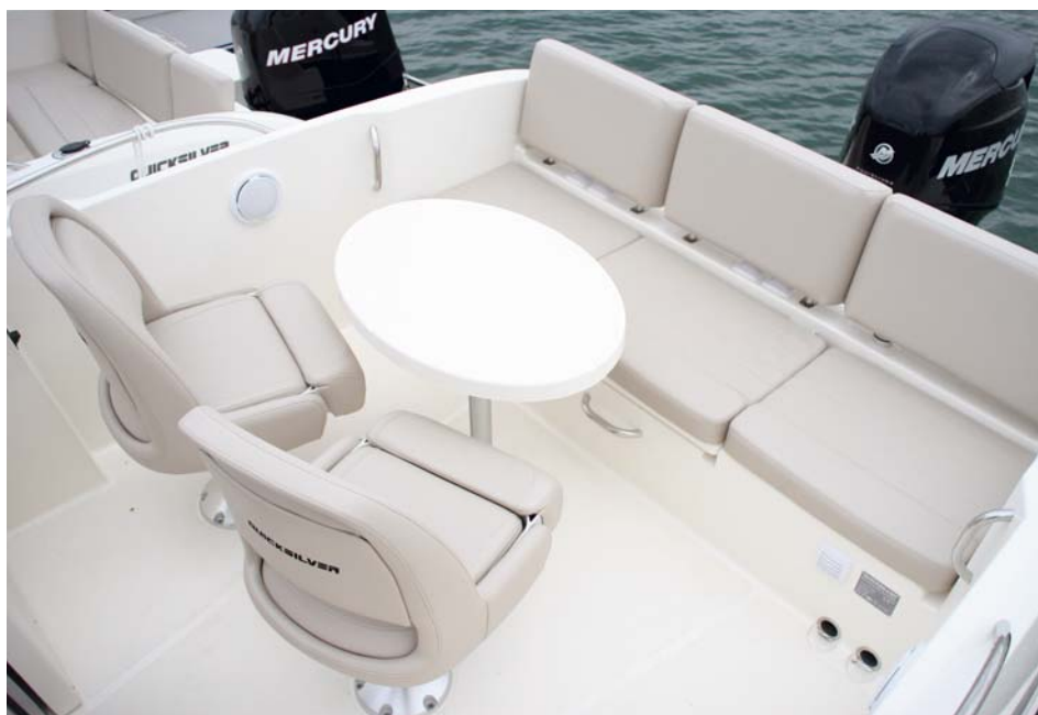
Con una mesa desmontable se forma una dinette añadiendo los asientos giratorios.
